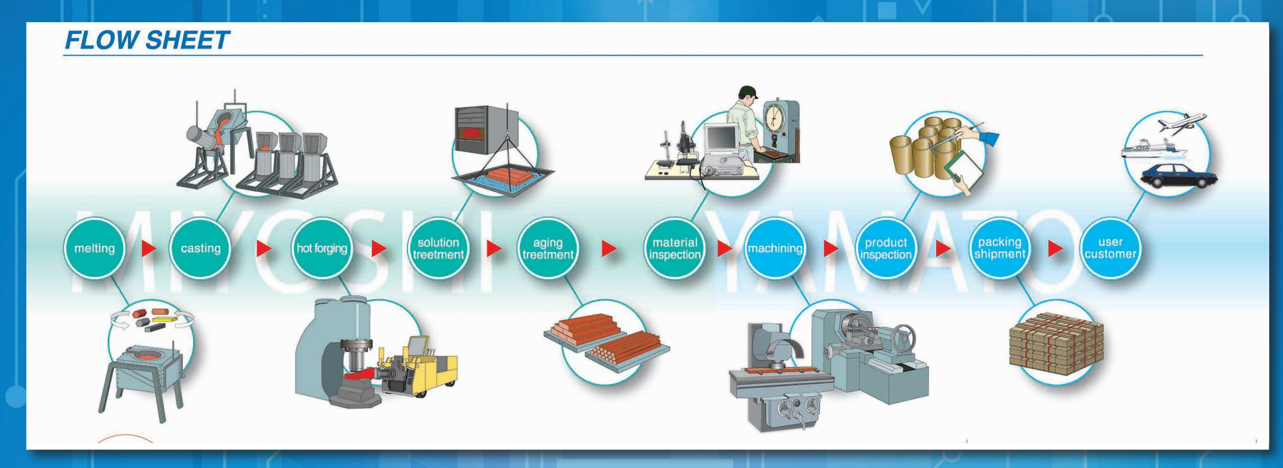
ランディングギア、アクチュエータ用のブッシングの銅合金素材を製造しています。 Raw material for Landing gear bushings Actuator bushings.
